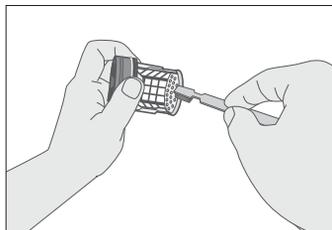
4. Смойте грязь и удалите другой мусор из фильтра. Убедитесь в том, что расположенные сзади фильтра лопасти сливного насоса не заблокированы грязью. Верните на место крышку фильтра.
