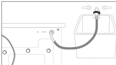
2. Подсоедините другой конец шланга для подачи воды к крану холодной воды, и затяните соединение рукой. В случае необходимости, вы можете изменить положение конца шланга для подачи воды, подключенного к стиральной машине, для чего ослабьте фитинг, поверните шланг и вновь затяните фитинг.
